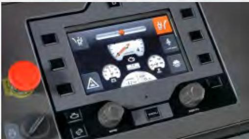
**GERADE SCHNITTE** Bei FS 5000 D und FS 7000 D ist das benutzerfreundliche Bedienfeld mit einem digitalen Monitor ausgerüstet, der den elektronischen Spurhaltungsmodus anzeigt, mit dem das Ausführen gerader Schnitte erleichtert wird und der eine hohe Produktivität ohne übermäßige Belastung des Bedieners ermöglicht.
