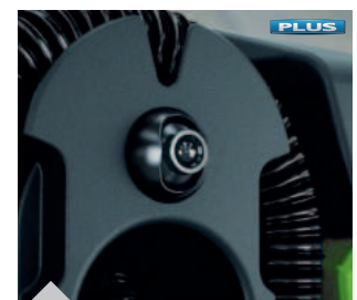
Hinterere Kamera zur Kontrolle der Reinigungsleistung
