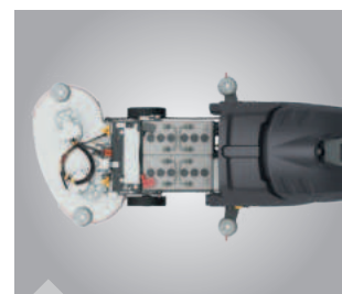
Bürstenköpfe austauschbar, dadurch nur eine Maschine mit unterschiedlichen Bürstenköpfen verwendbar statt verschiedene Maschinen
