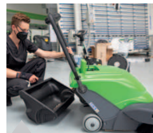
Großer Kehrgutbehälter Der Schmutz wird direkt in den Kehrgutbehälter befördert. Dieser ist leicht und einfach in der Handhabung.
