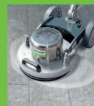
Aufarbeiten und Kristallisieren von Marmor
