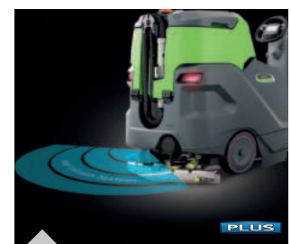
Kollisionsschutzsystem warnt bei Rückwärtsfahrt vor Hindernissen
