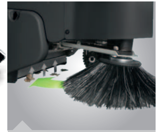
Hauptbürste mit elektrischer Staubabsaugung
