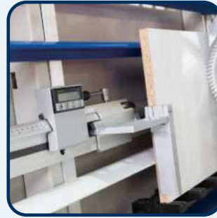
• Digitale Maßanzeige zur Längeneinstellung beim Vertikalschnitt
