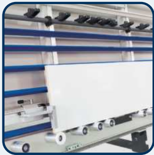
• Einfacher und schneller Zuschnitt auch kleiner Teile. Untere Plattenauflage mit Maßanzeige.
