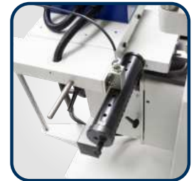
• Dübelbohrereinrichtung mit Rasterteilung 16 / 22 / 25 / 32
