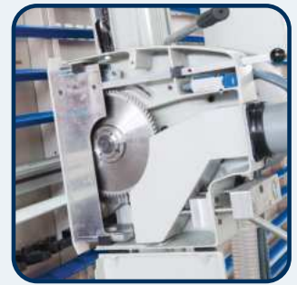
• Große Öffnung für Sägeblattwechsel
