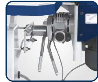
• Schleifaggregat über Hebel bis 45° schwenkbar
