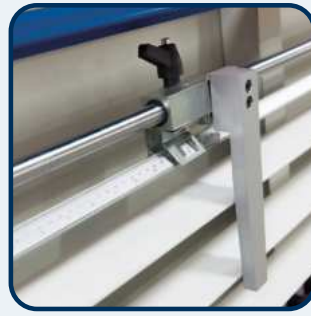
• Lineal zur Längeneinstellung beim Vertikalschnitt
