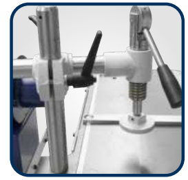
• Manueller Exzenterspanner mit großem Auflageteller zum Fixieren des Werkstücks
