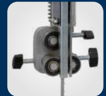
Sägeband-Präzisionsführung oben und unten
