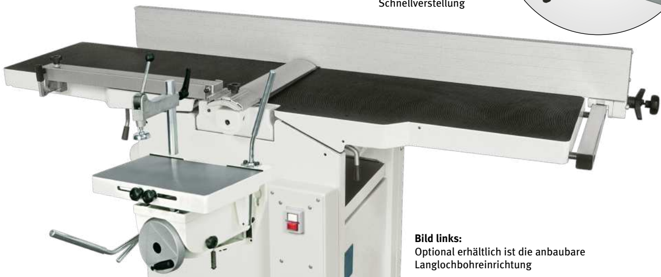
Bild rechts: Großer Abrichtanschlag aus eloxiertem Aluminium, 0 - 45° neigbar mit Schnellverstellung
