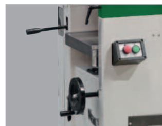
Dickenhobeln Höheneinstellung des Dickenhobels einfach und bequem über Handrad und Skala Spanabnahme bis zu 5 mm möglich
