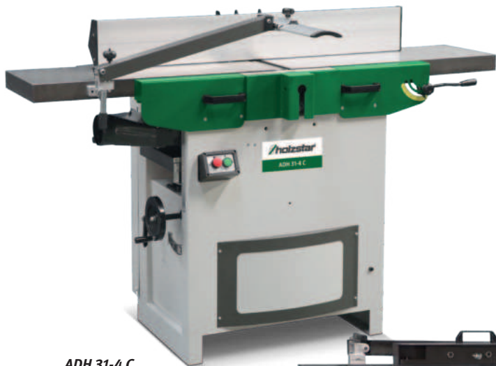
ADH 31-4 C Gerüstet zum Abrichthobeln
