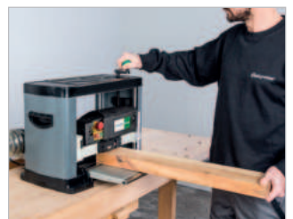
Höheneinstellung über Handkurbel und Skala
