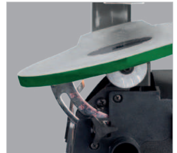
Tischwinkel über Skala genau einstellbar
