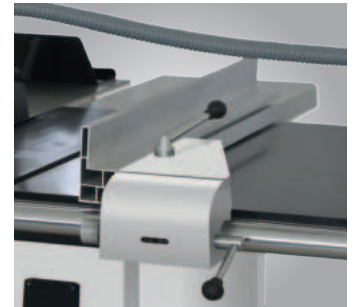
Großer Aluminium-Parallelanschlag auf Rundstangenführung mit Feineinstellung
