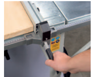
Der Parallelanschlag mit Exzenter-Schnellschraubung kann per Skala präzise und leicht eingestellt werden.
