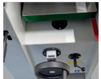
Dickentisch Führung auf mittiger Säule und Zusatzführung Höhenverstellung über Handrad Höhenanzeige durch mechanisches Zählwerk mit Genauigkeit 0,1 mm
