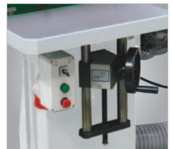
Höhenverstellbarer Schleiftisch zur Ausnutzung der gesamten Schleifbandbreite
