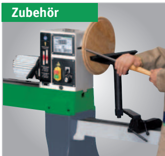
Für Drechselarbeiten an Werkstücken im Querholzbetrieb, die größer als das Stichmaß der Bank sind, kann der Spindelstock geschwenkt werden. Die optionale Bettverlängerung in Verbindung mit der umsteckbaren Handstahlaufgabe ermöglichen maximale Flexibilität.
