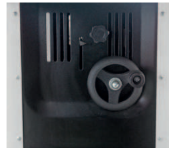
Spindelhöhe von 0 bis 40 mm einstellbar
