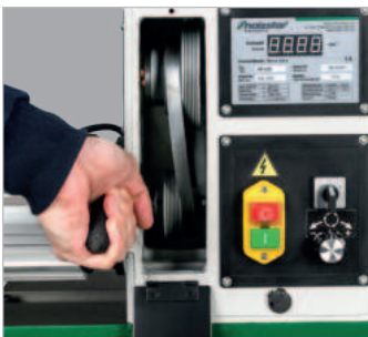
Werkzeugloses Wechseln der Übersetzungsstufe durch leichtes Ummontieren des Keilriemens
