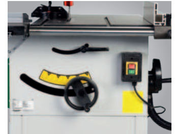
Mit genauer und leichtgängiger Höhen- und Schrägverstellung des Sägeaggregats durch einfach zu bedienendes Handrad
