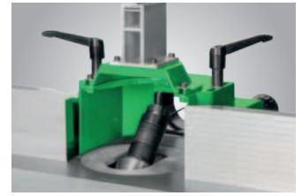
Nach hinten schwenkbare Frässpindel für optionalen Einsatz eines Vorschubapparates, ein Maximum an Sicherheit und ein sauberes Fräsbild
