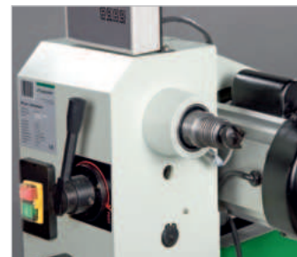
Über einen Hebel an der Bedienerseite ist die gewünschte Drehzahl schnell und bequem einstellbar
