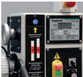
Variable Drehzahlregulierung in zwei Geschwindigkeitsstufen
