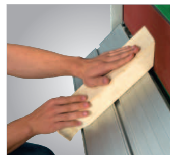
Gehrungen bis 45° durch Schwenken des Längstisches
