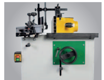
Handrad für Höhenverstellung. Sicherheitsvorrichtungen im Lieferumfang
