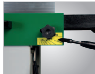
Verstellung der Spanabnahme über Bedienhebel
