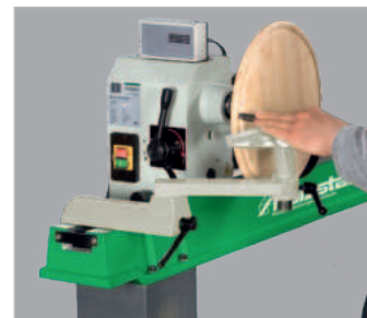
Für Dreharbeiten an Werkstücken im Querholzbetrieb, die größer als das Stichmaß der Bank sind, kann der Spindelstock geschwenkt werden. Die Bettverlängerung in Verbindung mit der umsteckbaren Handstahlaufgabe ermöglichen maximale Flexibilität.
