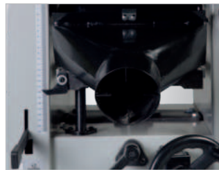
Dickentischverstellung über Handrad, Skala und numerischer Anzeige
