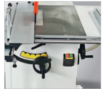
▶ Sägeblatthöhe und -schwenkung bequem über Handräder einstellbar
