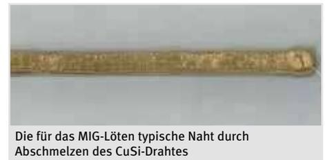
Die für das MIG-Löten typische Naht durch Absmelzen des CuSi-Drahtes
