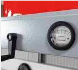
Filterüberwachung über Manometer
