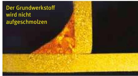
Durch die Verwendung von Zusatzwerkstoffen auf Kupferbasis (Bronze) kann mit geringer Wärme gearbeitet werden. Durch die geringe Wärmezufuhr verdunstet nur noch wenig Zink und der Bauteilverzug ist reduziert. Die Festigkeitswerte sind relativ hoch und die Lötnaht ist aufgrund der Legierungsbestandteile korrosionsbeständig, da der Zusatzwerkstoff aus Bronze besteht.
