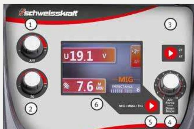
④ Drehknopf und Drossel für ARC-Force und Down-Slope
