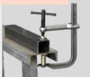
▶ Überschreiten mittels aufschraubbarem Zusatzblock
