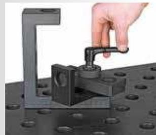
▶ Werkzeuglose Klemmung eines Vario Spannbolzen 28 K
