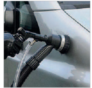
▶ Strahlmittel wird nach dem Auftreffen auf die Oberfläche sofort wieder abgesaugt und zurückgeführt
