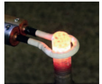
Erwärmen eines Gewindebolzens mit der wassergekühlten Spule
