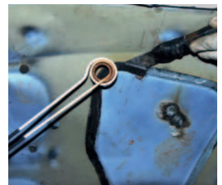
Zur einfachen Entfernung von kleineren Verkleidungen
