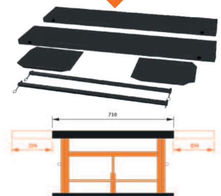
MHB 680 mit seitlicher Erweiterung
