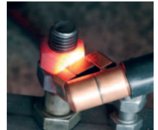
Erwärmen einer Mutter mit der Fokusspule schräg
