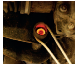
Zum Erwärmen und Lösen von festsitzenden und angerosteten Teilen
