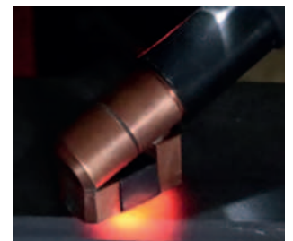
Erwärmen eines Bauteils mit der Fokusspule seitlich
