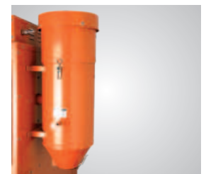
Integrierte Absauganlage mit auswechselbarem Luftfilter
