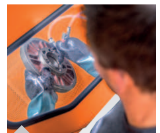
Optimale Sicht auf den Arbeitsbereich dank heller Innenraum-Beleuchtung und großem Sichtfenster
